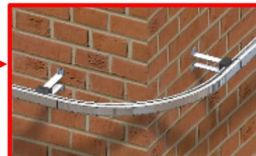
Lorsque vous installez un mur extérieur courbe, faites attention à l'interférence avec l'angle. Un support supplémentaire peut être nécessaire.
