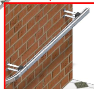
Distance maximale entre les supports : 6 m (3 m en cas d'accès par corde)
